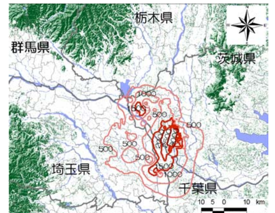
図-6 短期的地下水位変動に起因する地盤圧縮量 (単位 mm)
