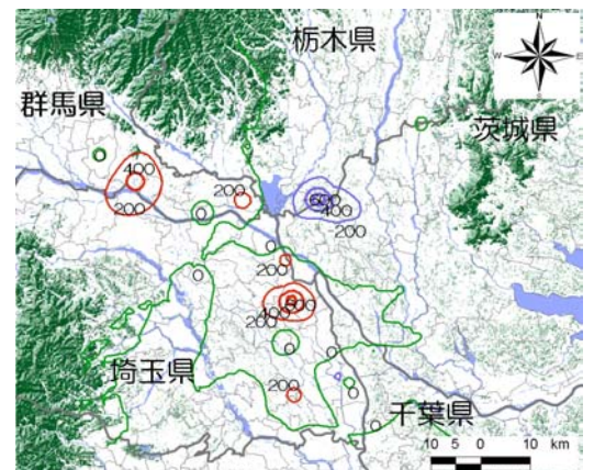
図-7 その他の要因に起因する地盤圧縮量 (単位 mm)
