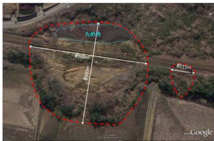
図 1.2 鉄道盛土崩壊 （スケールは目視と Google Earth による距離測量により判読）
